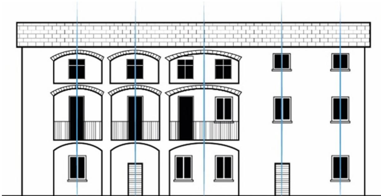
Esempio stato di progetto da non perseguire: recupero delle grandi aperture tramite serramenti arretrati e tamponatura che lasci in evidenza la sagoma originale.
